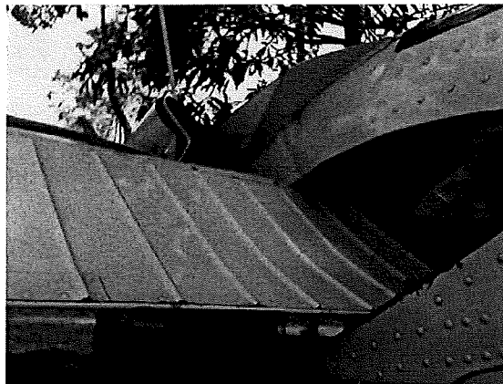
k. FLAPS, DAÑADOS. FLAP DERECHO e IZQUIERDO, ROMPIERON LAS VENTANAS TRASERAS, AL CORRERSE LAS ALAS
